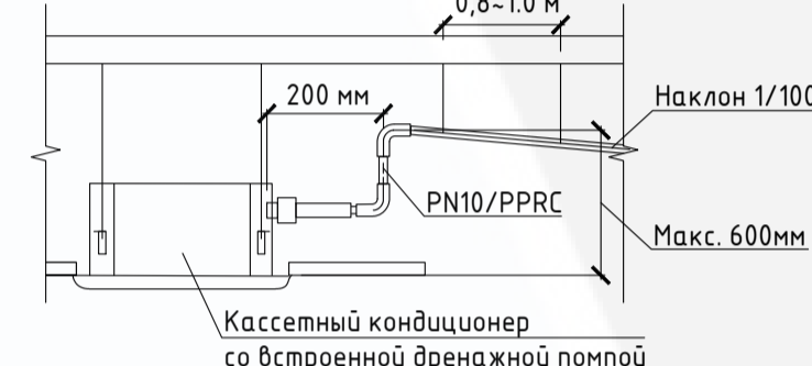
Принципиальная схема отвода дренажа от внутренних блоков кассетного типа.
